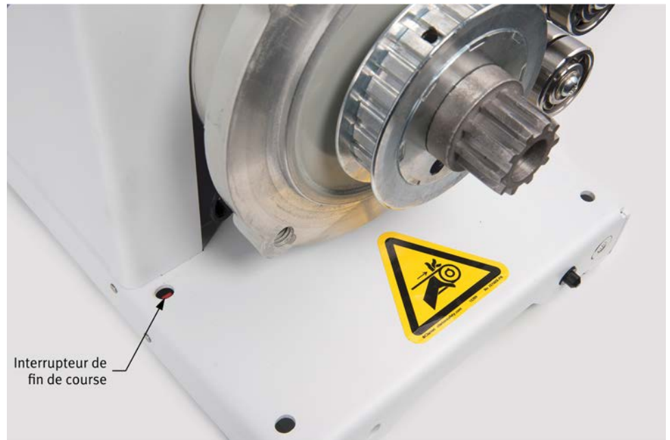
Figure 20 : Un interrupteur de fin de course dans le socle de chaque machine tournante empêche le fonctionnement de la machine tant qu'un capot de protection n'est pas installé.
