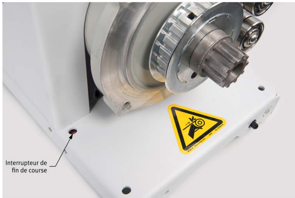
Figure 17 : Un interrupteur de fin de course dans le socle de chaque machine tournante empêche le fonctionnement de la machine tant qu'un capot de protection n'est pas installé.
