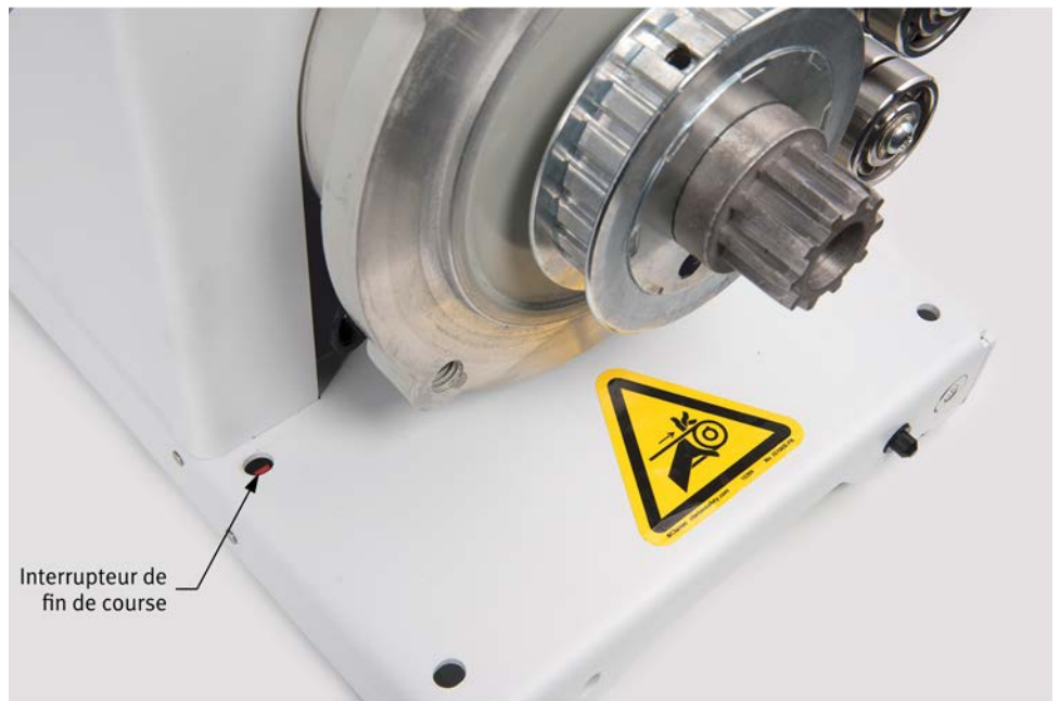
Figure 12 : Un interrupteur de fin de course dans le socle de chaque machine tournante empêche le fonctionnement de la machine tant qu'un capot de protection n'est pas installé.
