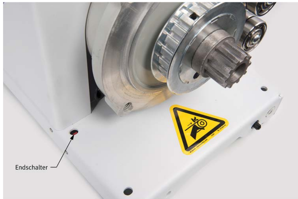
Abbildung 15: Ein Endschalter in der Grundplatte jeder rotierenden Maschine verhindert den Betrieb, solange keine Schutzabdeckung ordnungsgemäß installiert ist.
