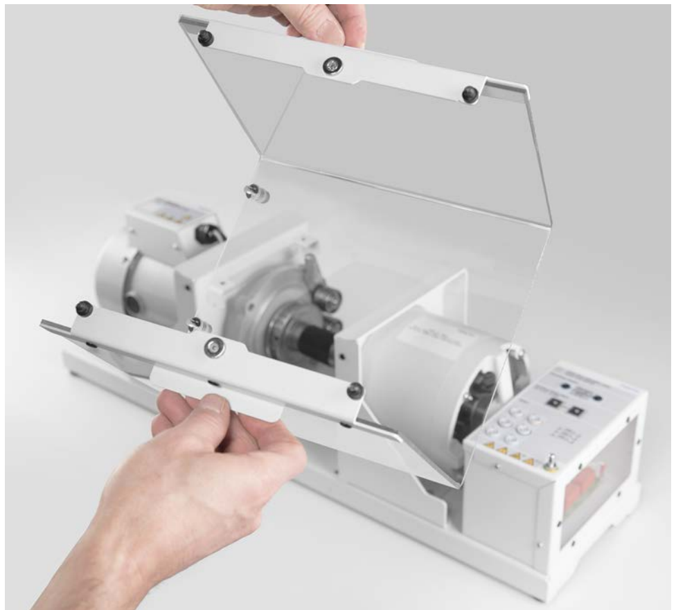
Abbildung 16: Führungsstifte an der Unterseite der Schutzabdeckung für Inline-rotierende Maschinen.
