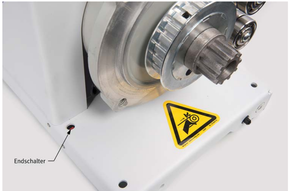
Abbildung 18: Ein Endschalter in der Grundplatte jeder rotierenden Maschine verhindert den Betrieb, solange keine Schutzabdeckung ordnungsgemäß installiert ist.
