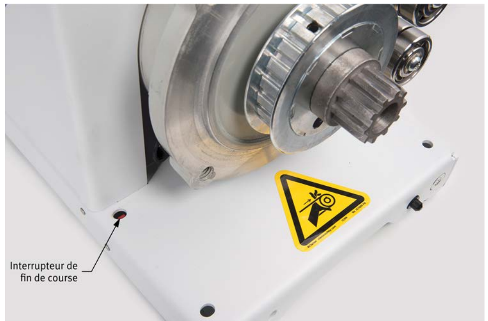
Figure 18 : Un interrupteur de fin de course, situé dans la plaque de base de chaque machine tournante, empêche le fonctionnement tant que le carter de protection n'est pas correctement installé.
