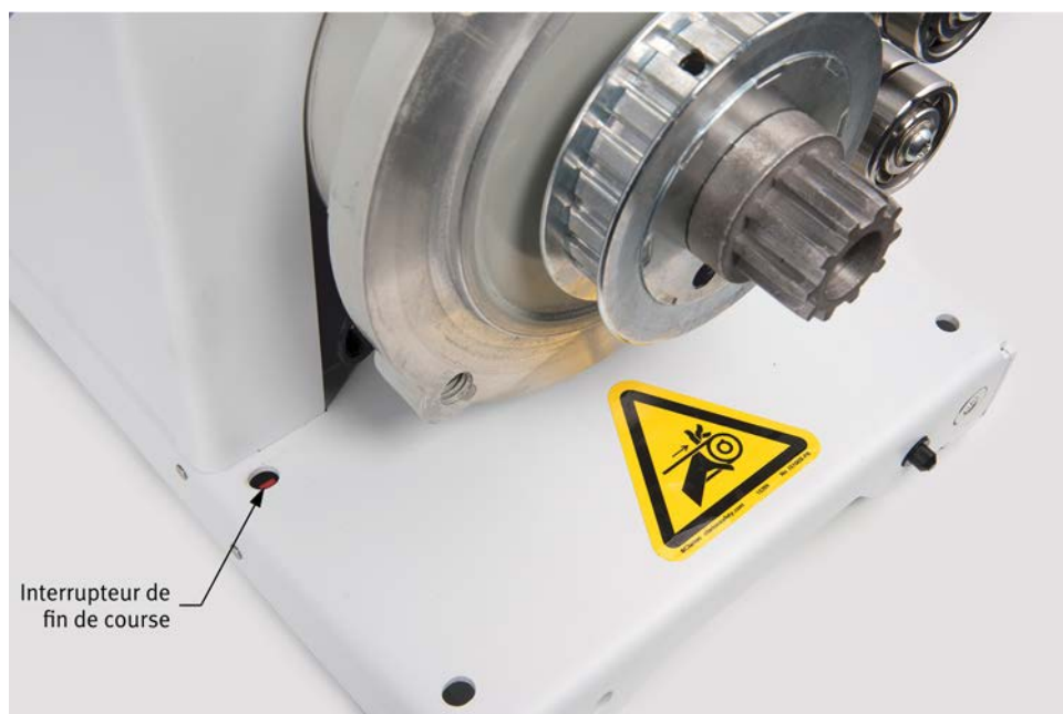
Figure 10 : Un interrupteur de fin de course dans la plaque de base de chaque machine tournante empêche le fonctionnement tant qu'un protège-machine n'est pas correctement installé.
