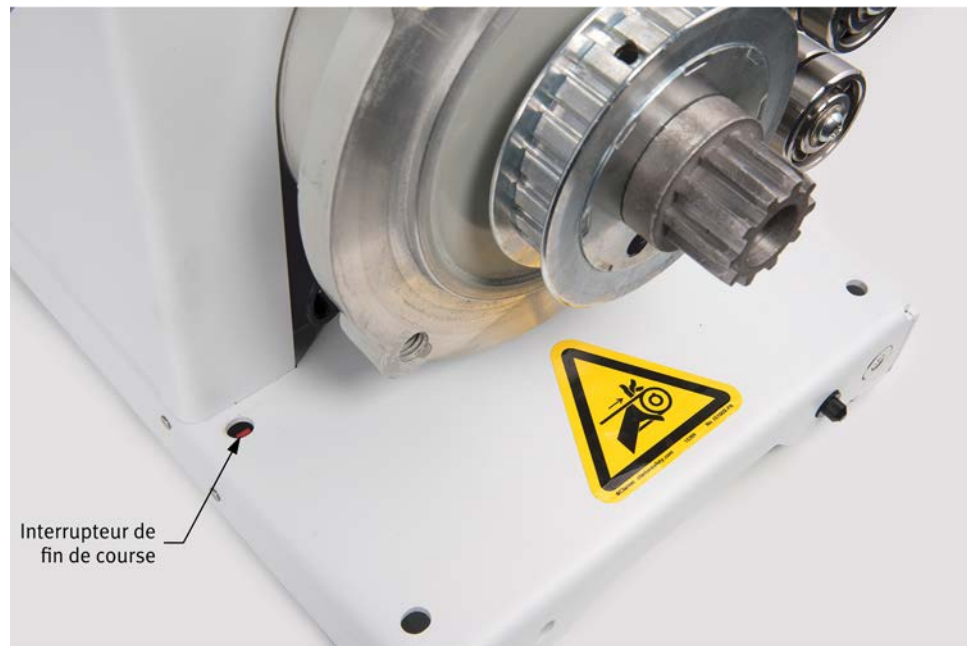
Figure 15 : Un interrupteur de fin de course, situé dans la plaque de base de chaque machine tournante, empêche le fonctionnement tant que le capot de protection n'est pas correctement installé.
