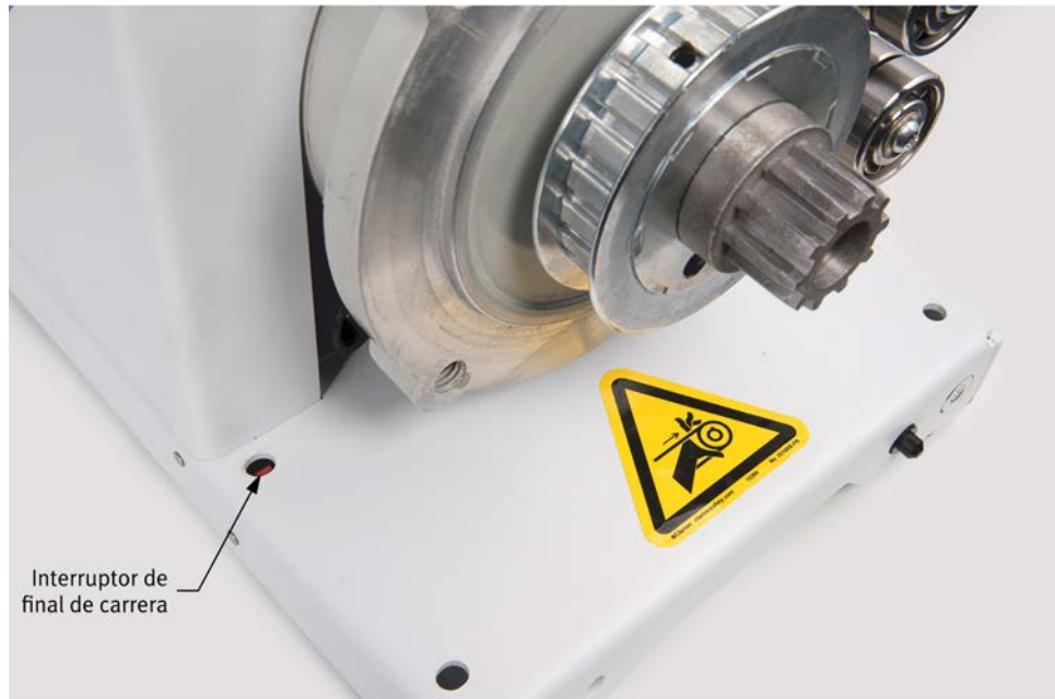
Figura 18: Un interruptor de límite en la placa base de cada máquina rotativa impide el funcionamiento si no se instala correctamente un capot de protección.
