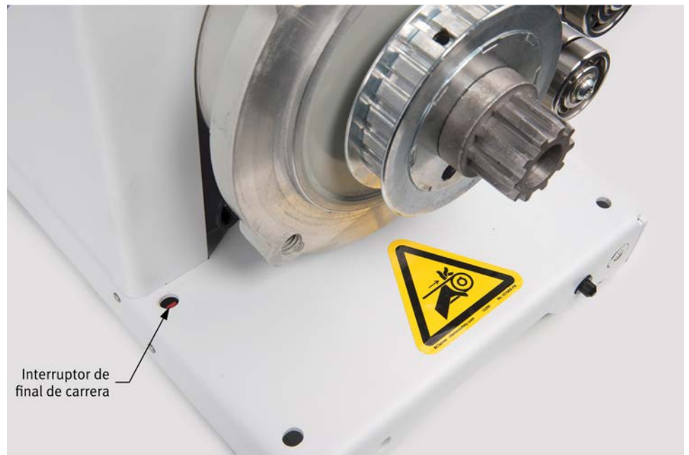
Figura 10: Un interruptor de límite en la placa base de cada máquina rotativa impide su funcionamiento mientras no se haya instalado correctamente un capot de protección.
