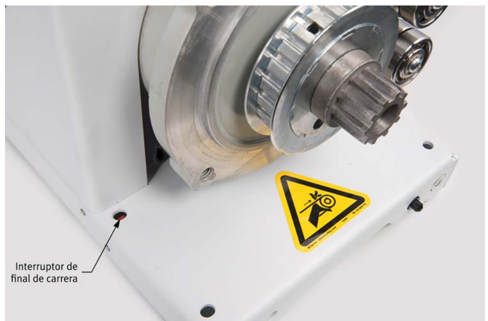
Figura 15: Un interruptor de límite en la placa base de cada máquina rotativa impide el funcionamiento mientras no se instale correctamente un capot de protección.
