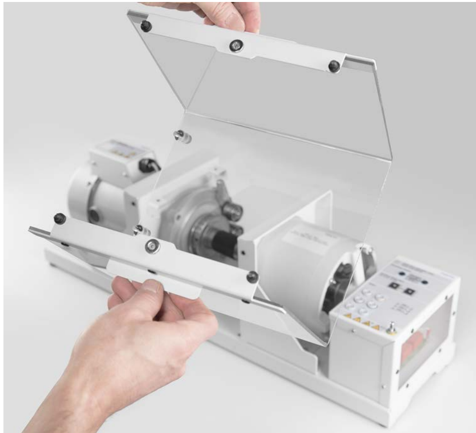
Figura 16: Pasadores de guía en la parte inferior del capot de protección para máquinas rotativas en línea.
