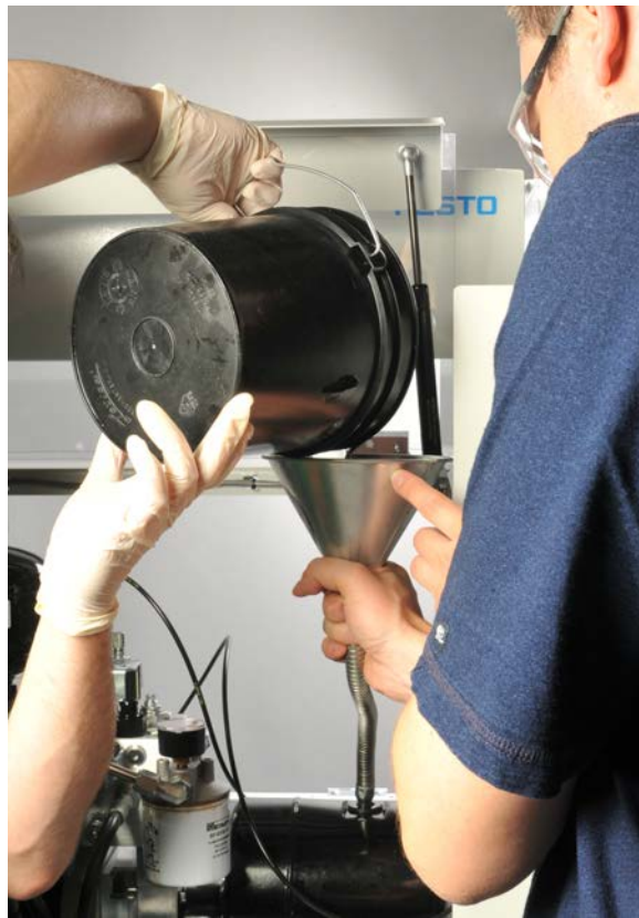
Figura 67: Llenado del tanque de aceite hidráulico.
