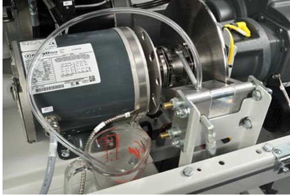
Figura 68: Preparación para el purgado del freno del rotor.
