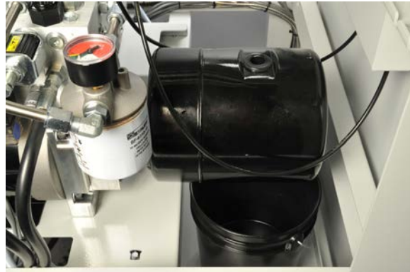
Figura 63: Colocación del cubo.
