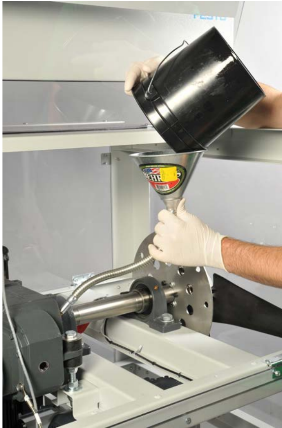
Figura 62: Llenado de aceite nuevo en el reductor.
