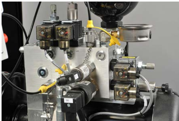
Figura 27: Los solenoides de la unidad hidráulica pueden calentarse.
