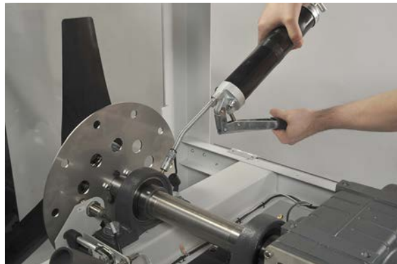
Figura 58: Inserción de la pistola de grasa en el punto de engrase del bloque de soporte.
