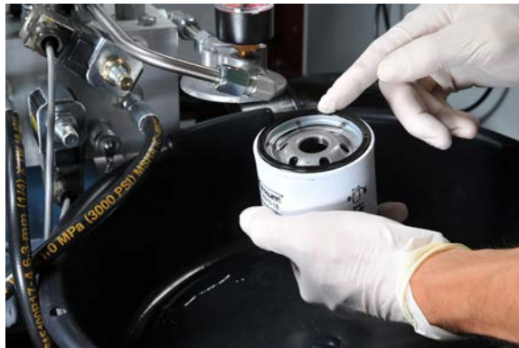
Figura 66: Recubrimiento de la junta del filtro con aceite.
