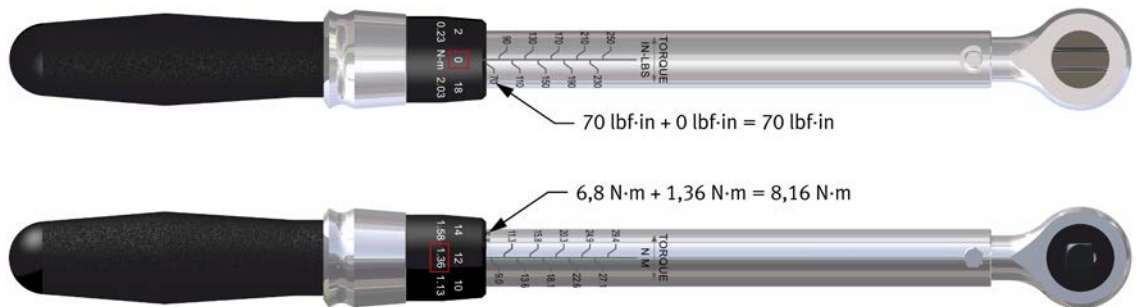
Figura 50: Ejemplos de ajustes de la llave (escala métrica y SAE).
