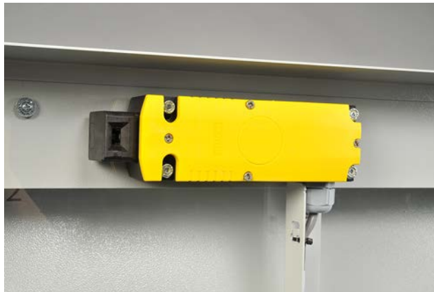
Figura 29: Mecanismo de seguridad de las puertas superiores.
