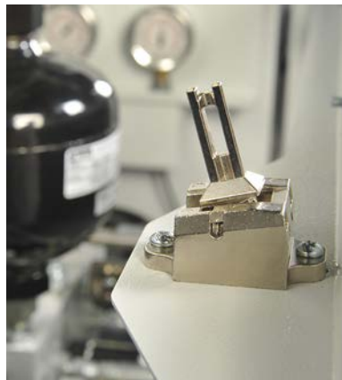
Figura 30: Mecanismo de seguridad de las puertas laterales.
