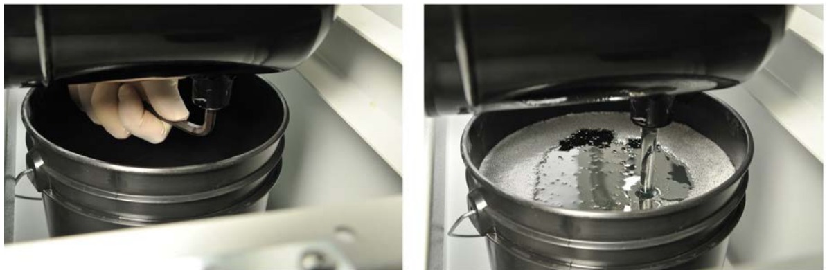
Figura 64: Desenroscado del tapón de drenaje.
