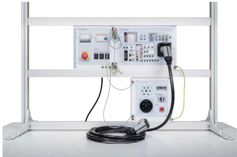
Abbildung 7: Aufbau-Beispiel Typ 2 ohne M&A.
