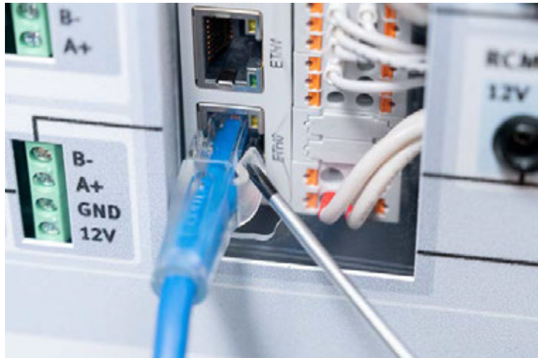
Abbildung 3: Zum Entfernen des Ethernet-Kabels müssen Sie eventuell mit einem kleinen Schraubendreher auf die Lasche drücken.
