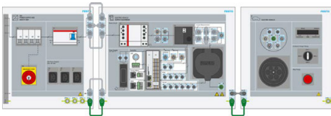
Abbildung 5: Anschlussplan für die Ladestation (Typ 2).
