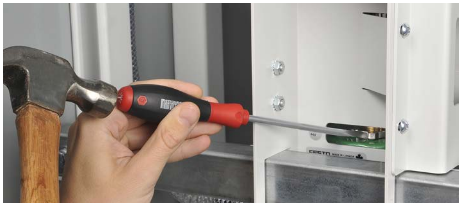
Figure 10 : Dévisser le contre-écrou de l'actionneur pour desserrer le corps de la vanne.
