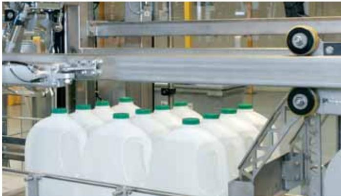
Rollcontainer-Bestückungssystem von Elopak: Die befüllten Behälter werden erst gruppiert und dann auf die einzelnen Etagen eines Rollcontainers geladen.
