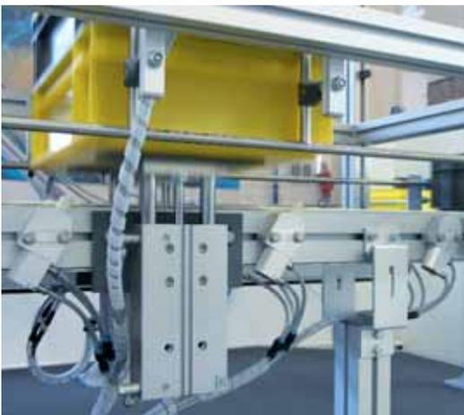
von FlexLink Deutschland, Peter Nauwerck. Die Kompaktzylinder sind genauso kraftvoll wie Normzylinder, benötigen aber nur die Hälfte des Bauraums. Dabei passt pneumatisch eins ins andere und kommt aus einer Hand: CPV-Ventilinseln mit AS-Interface-Ansteuerung sowie Wartungsgeräte der Festo D-Reihe komplettieren die pneumatische Automatisierung der Förderanlage.
