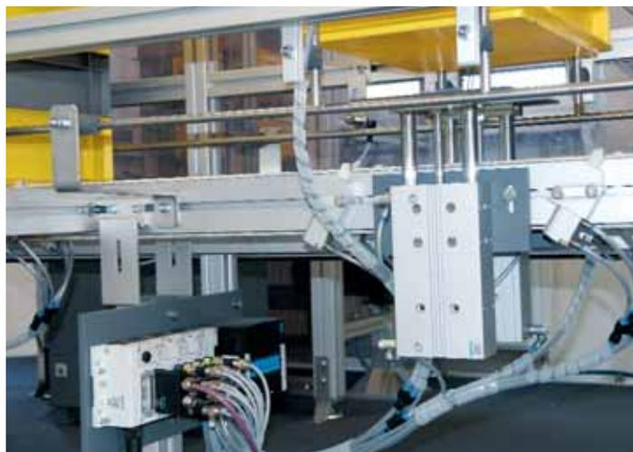
Das modulare elektrische Terminal CPX: Ideal für Einsätze in der Nahrungsmittel- und Prozessindustrie – wie hier in einem Kistentransporter der Firma FlexLink.
