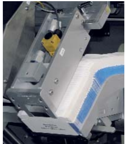
Después: separación rápida de las cajas con el músculo neumático MAS
