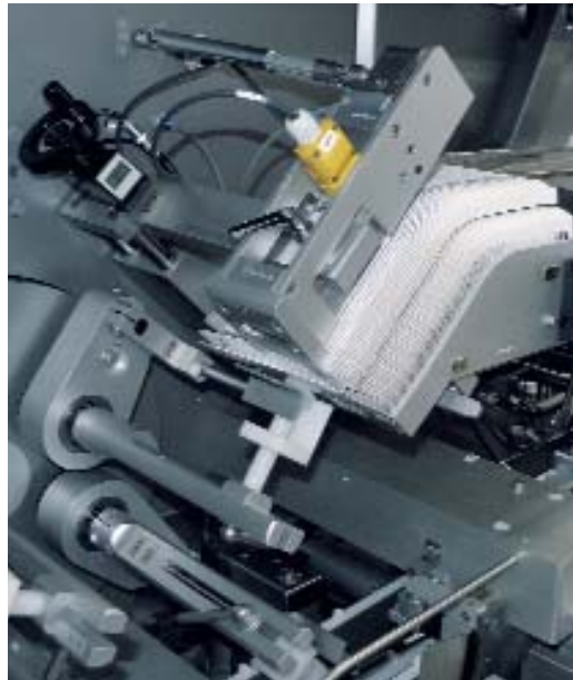
Antes: complicada separación de cajas mediante disco de levas
