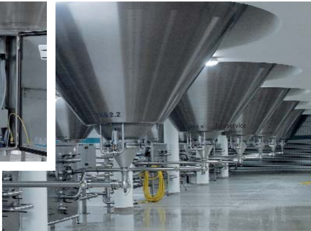
Una típica fábrica de cerveza de la industria híbrida con automatización de procesos con terminales de válvulas CPV del bus de campo en el depósito de fermentación de cerveza.
