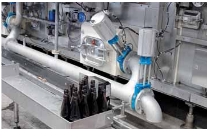
Prozessantriebe von Festo vom Typ DLP: In der Flaschenwaschanlage Innoclean von KHS zum Öffnen und Schließen der Klappen in der Reinigungslaugen-Zuführung
