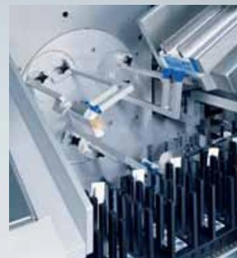
3 In der Packgutkette des Kartonierers werden die Blister in Schächte gestapelt. Parallel dazu die passenden Faltschachteln abgenommen, aufgerichtet und in eine zweite Kette hinter die Blister gelegt.
