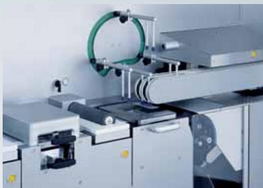
2 An der Stanzstation erhalten fehlerhafte Blister – durch Kamerakontrolle identifiziert – eine spezifische Stanzkontur und werden aus dem Verpackungsprozess ausgeschleust.
