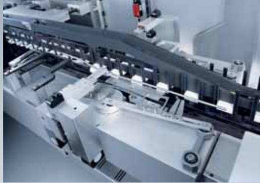
5 Nach dem Befüllen kommen die Faltschachteln zur Verschlussstation. Vom Einsteckverschluss bis zur Heißklebung sind alle gängigen Verschlussysteme möglich.
