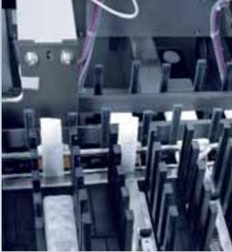
4 Sind alle Bestandteile in Reihe gebracht, wird der Blister mit dem Beipackzettel in die Faltschachtel eingeschoben.
