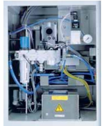
▲ Einbaufertig von Festo geliefert: kundenspezifische Wartungseinheit mit integriertem Drucksensor SDE3.
