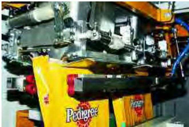
**¿Sabía usted cómo se introduce bajo presión comida para perros en bolsas? Pneumatic World fue testigo cómo una máquina para llenar bolsas de diversos formatos de Cetec Industrie funciona con elementos neumáticos. Las bolsas se llenan de alimentos secos para perros, listos para el consumo.**
