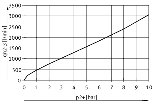
Durchfluss q_{n2-3} von 2 → 3 in Abhängigkeit vom Ausgangsüberdruck p_{2+} , VPPM-8L/F-...-0L10H-... (10 bar)
