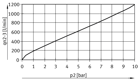
Durchfluss q_{n2-3} von 2 → 3 in Abhängigkeit vom Ausgangsüberdruck p_2 , VPPM-6L/F-...-0L10H-... (10 bar)
