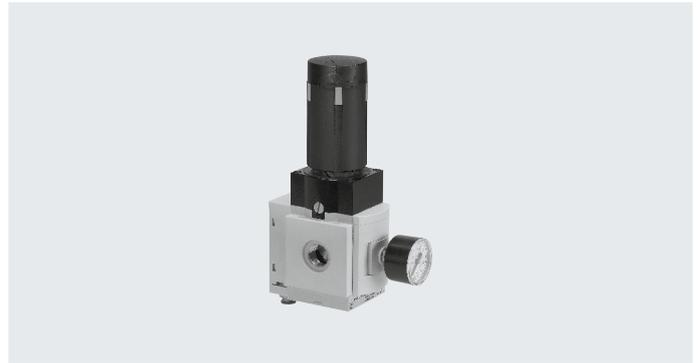
Dentro del margen de regulación de la presión, es posible ajustar la presión de salida p2 manualmente con el botón giratorio o neumáticamente mediante una presión de mando p12 con un regulador piloto externo (a ser posible, con un regulador de presión de precisión). Al desconectar la presión de entrada p1, se descarga la presión de salida p2 a través de la conexión 3 (descarga de aire secundaria).
