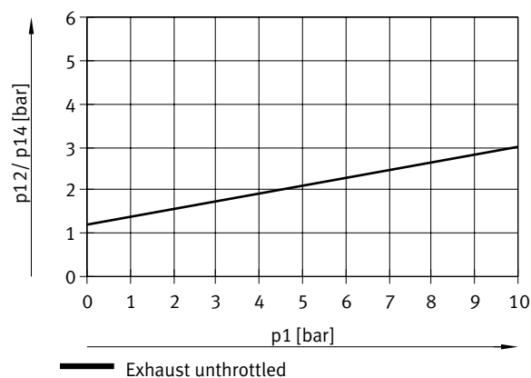
マスタバルブ 5ポート方向制御バルブ, 作動圧力 p_1 に応じた最低パイロット圧力 p_{12}/p_{14} , VL-5-1/2
