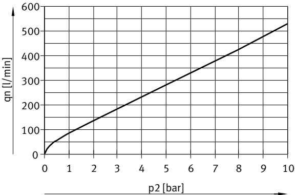
Débit qn en fonction de la pression de sortie p2, VPPE-3-1-1/8-10-..., qn 2 -> 3
