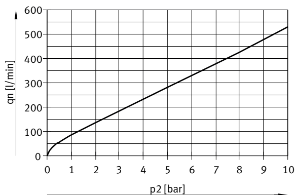
Natężenie przepływu q_n w zależności od ciśnienia wyjściowego p_2 , VPPE-3-1-1/8-10-..., q_n 2 \rightarrow 3
