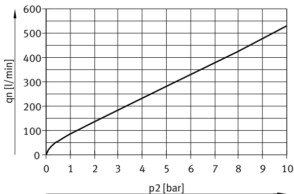
Debitul q_n în funcție de presiunea de ieseire p_2 , VPPE-3-1-1/8-10-..., q_n 2 \rightarrow 3
