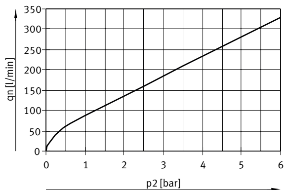
Protok q_n u zavisnosti od izlaznog pritiska p_2 , VPPE-3-1-1/8-6-..., q_n 2 -> 3
