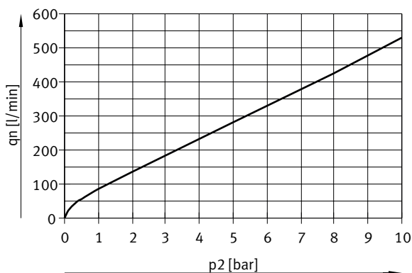
Protok q_n u zavisnosti od izlaznog pritiska p_2 , VPPE-3-1-1/8-10-..., q_n 2 \rightarrow 3
