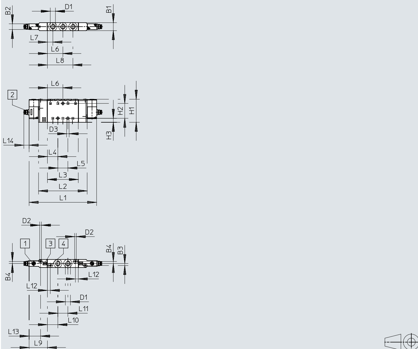
rozměry – CPE14, elektromagnetické ventily s kulatým konektorem M8x1
