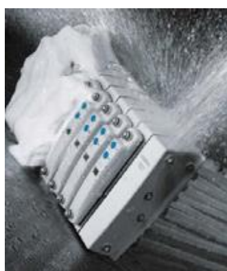
Diseñado para el lavado, el colector de válvulas MPA-C de Festo cumple con la norma IP69K de la calificación. Obsérvese el diseño redondeado que elimina los espacios muertos.
