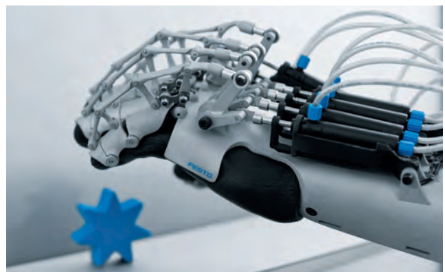
Pneumatisches Exoskelett: flexibel bewegen mit allen Freiheitsgraden
