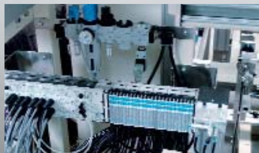
Ampliación por módulos: el terminal de válvulas MPA con el terminal eléctrico CPX para todas las E/S y conexiones de bus de campo.
