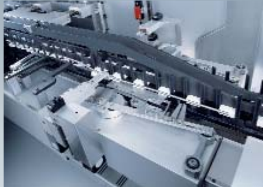
5 Las cajas llenas pasan a la estación de cierre. La máquina permite cerrar las cajas de diversas formas, ya sea mediante tapa con lengüeta o con tapa con pegamento activado térmicamente.
