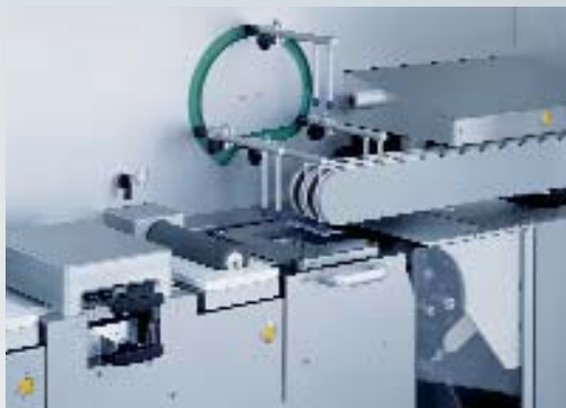
2 En la estación de corte, las cámaras detectan los blíster defectuosos (controlando su silueta) para retirarlos del proceso de embalaje.
