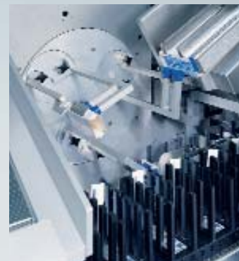
3 Los blíster se apilan en la cinta de la máquina de embalaje en cajas de cartón. Al mismo tiempo se retiran las cajas apropiadas para colocarlas correctamente orientadas en una segunda cinta de transporte, detrás de los blíster.
