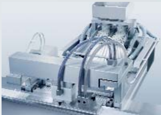
1 El sistema de alimentación Multi Tab coloca las tabletas en las placas mediante vibración. Los vanos de las placas son iguales a los vanos de la lámina moldeable.
