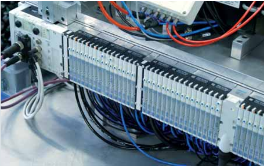
Zwei CPX/MPA-Ventilinselkombinationen versorgen die gesamte Pneumatik auf dem Fertigungsautomaten.
