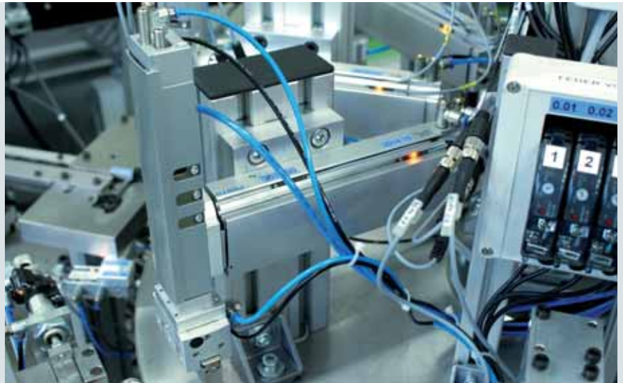
Zwei DGS-Minischlitten kombiniert zu einer Pick-and-Place-Einheit.
