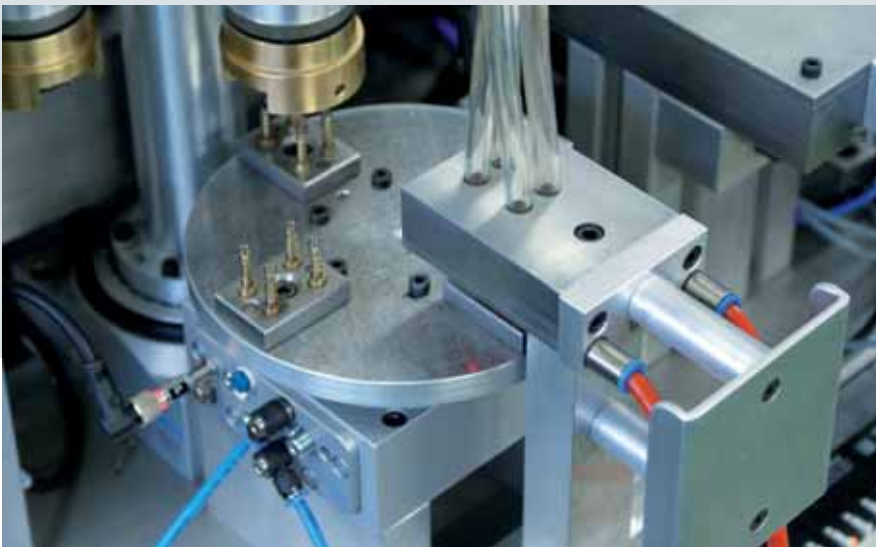
Zwei Rundschttsiche vom Typ DHTG nehmen auf Messingstiften vier Federn auf und stellen sie für die Bestückung bereit.
