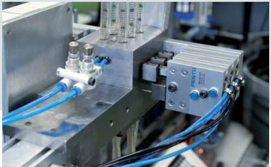
Die Vereinzelnung der Federn übernimmt ein HPV-Vereinzler von Festo.
