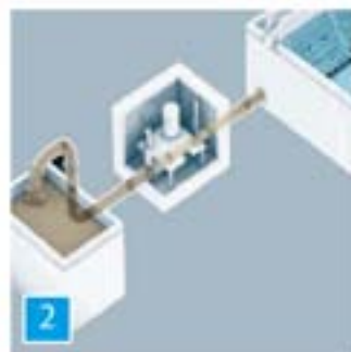
Pompage des boues Pour transférer en toute sécurité les boues, nous proposons une automatisation robuste et fiable des vannes à guillotine synchronisées avec l'opération de pompage
