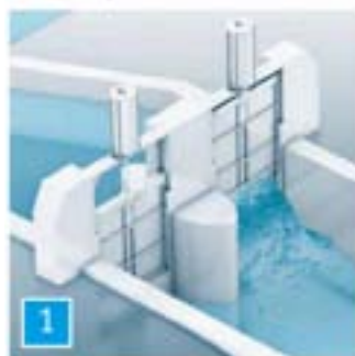
Automatisation d'une vanne à guillotine d'entrée de station Système d'automatisme assurant le fonctionnement complet de la vanne à guillotine en mode ouverture/fermeture ou régulation de position
