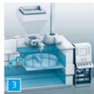
Mélange et dosage de flocculant Automatisation du processus de production et distribution de produit flocculant par la gestion automatique des vannes, actionneurs et moteurs de l'installation
