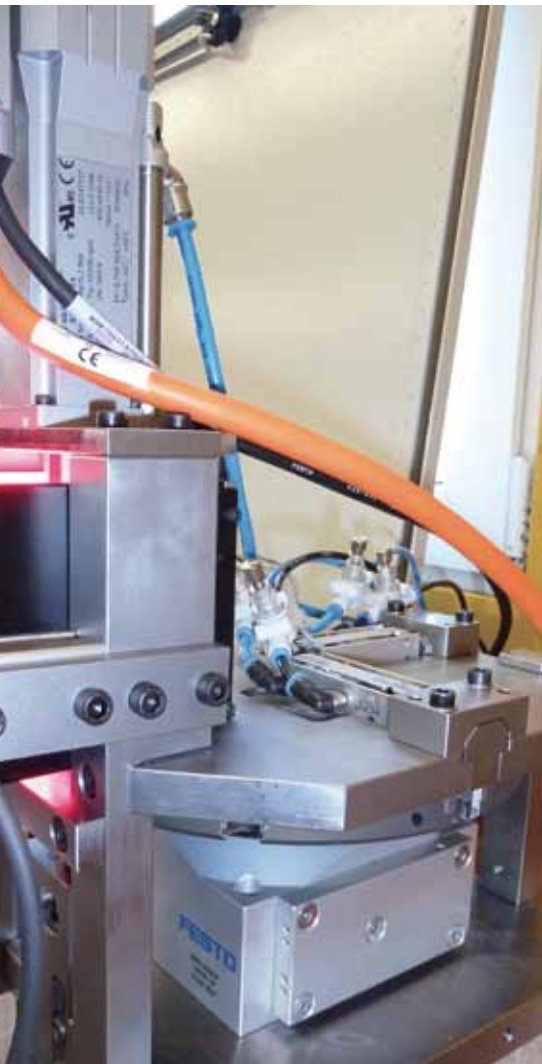
Ein pneumatischer Rundschalttisch vom DHTG taktet die Bauteile durch den Kontrollbereich.
