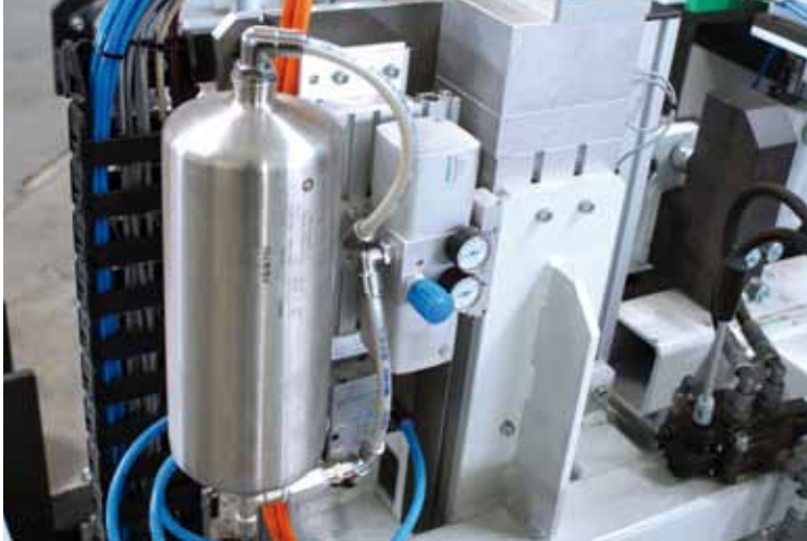
Druckbooster DPA zur Unterstützung bei Einschwenken der Platine.
