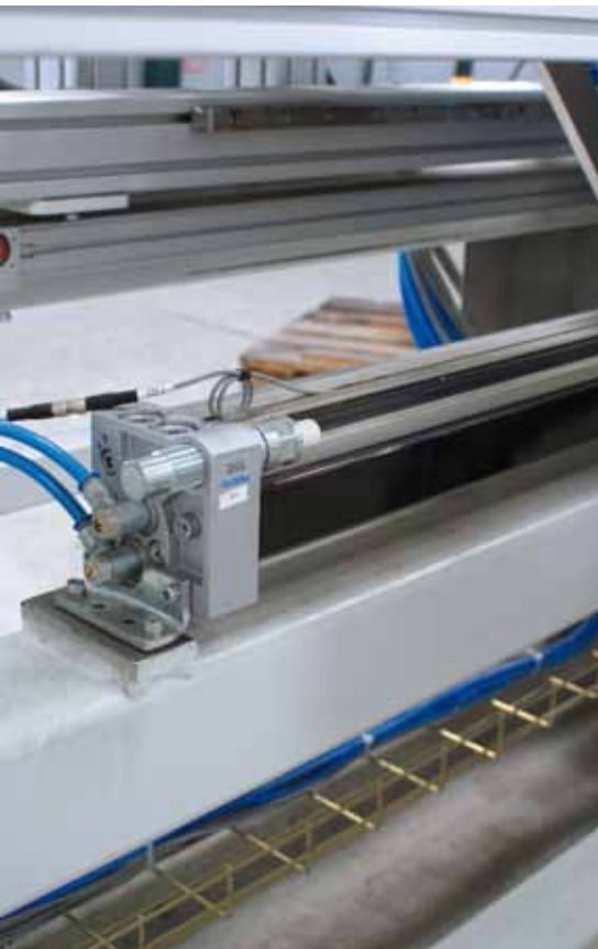
Ein kolbenstangenloser DGC-Zylinder schiebt die fertige Kassette in die Stapelstation.
