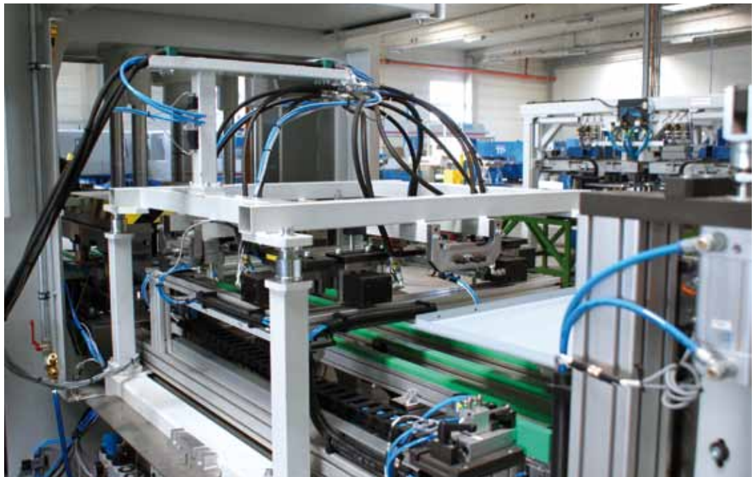
Blick in die Anlage zur vollautomatischen Fertigung von Standard- Metalldecken.
