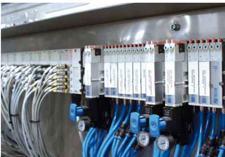
CPX/MPA-Ventilinselkombination zur Ansteuerung der elektrischen und pneumatischen Komponenten in der Prägestation.
