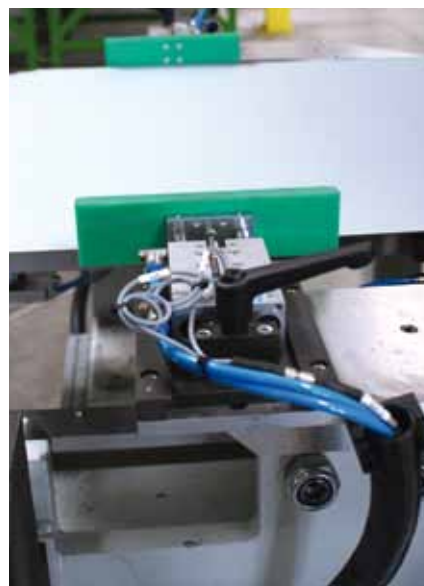
Zwei DFM-Zylinder zentrieren die Platinen im Bereich der Zuführung.
