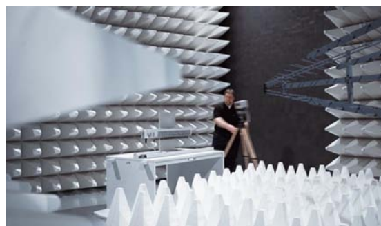
Abbildung 1: Prüfung von Ventilen auf elektromagnetische Verträglichkeit-im EMV-Labor von Festo
