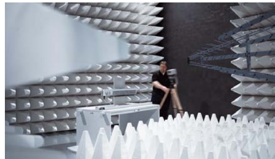
Fig. 1: control de válvulas en el laboratorio de compatibilidad electromagnética (CEM) de Festo
