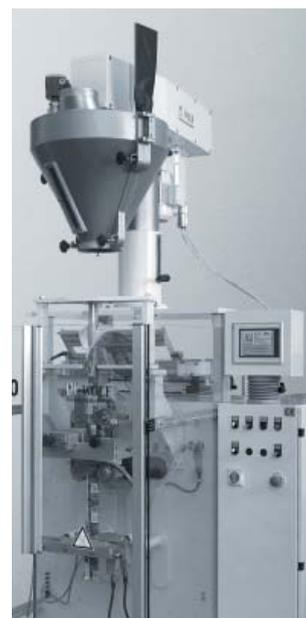
Conçu et intégré par Festo : un système de diagnostic/surveillance d'état pour une ensacheuse tubulaire
