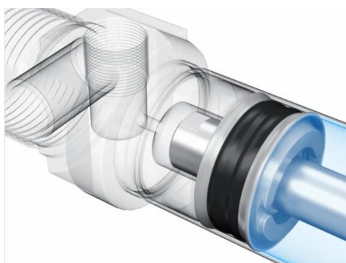
Vista interior del accionamiento de cilindro con amortiguación P de elastómero
