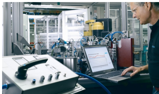
Abbildung 11: Messung des Druckluftverbrauchs
