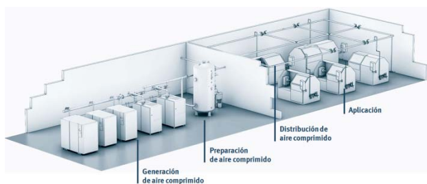
Figura 4: Es posible ahorrar en todo el sistema de aire comprimido
