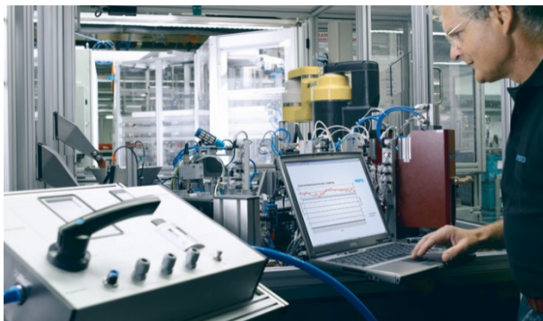
Figura 10: Medición del consumo de aire comprimido
