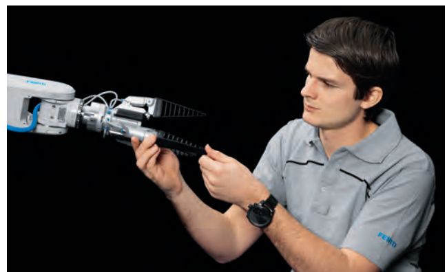
... in Kombination mit adaptiven Fingern mit Fin Ray®-Struktur
