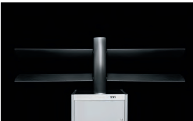
Neuartiges Konzept: gegenläufige Flügelpaare mit linearer Hubbewegung ...
