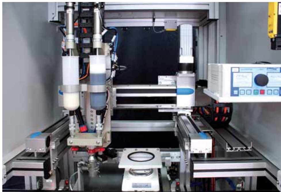
2 K-Klebstoff-Dosierstation von M-Tech mit einbaufertiger Handling-Lösung von Festo.
