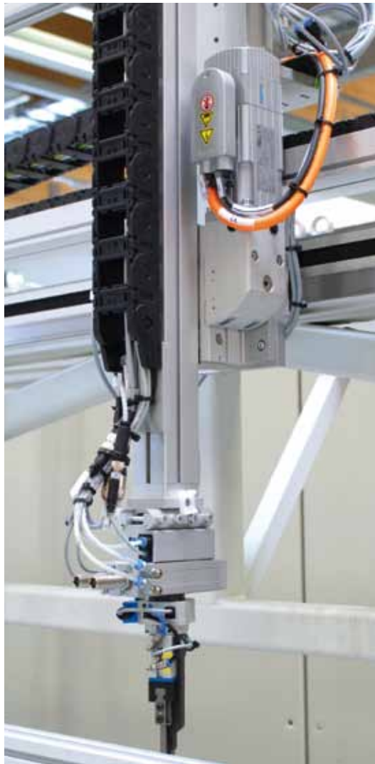
Bestückungseinheit: Z-Achse DGEA mit Motor EMMS und Schwenkgreifeneinheit DRQD/DHPS aus dem Festo Baukastensystem.
