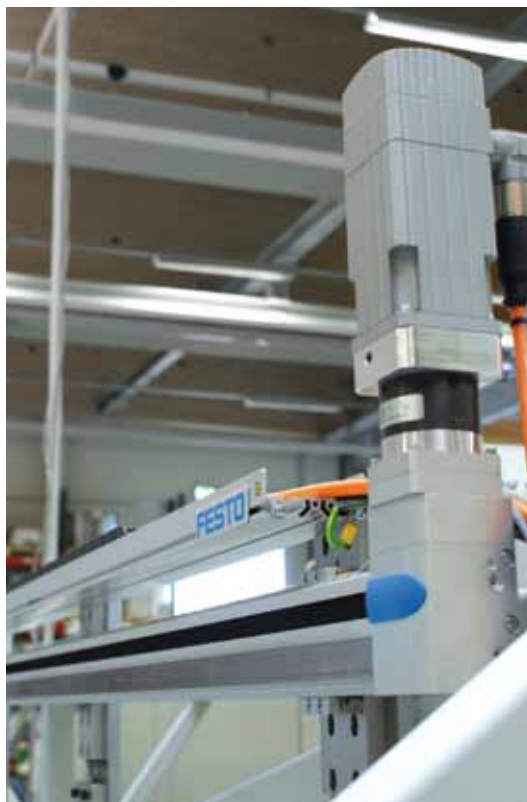
EGC 120- Zahnriemenachse mit 5.150 mm Hub als Achse für den Längsverschub.
