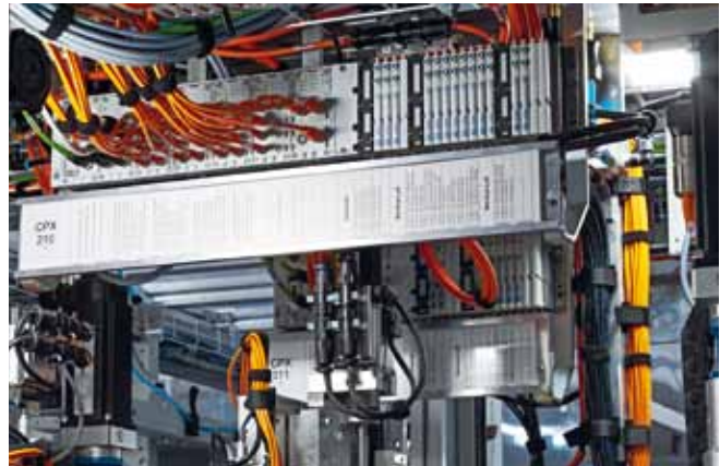
Steuert zuverlässig und präzise: Eine von zahlreichen Festo CPX-Ventilinseln sorgt für reibungslose Prozesse.
