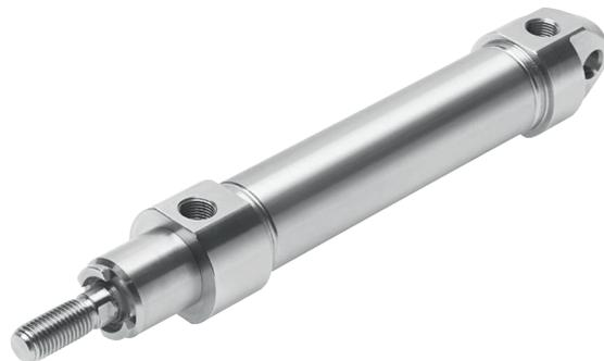
Vermeidung von Infektionsherden bei den Edelstahl-Rundzylindern CRDSNU von Festo: Der Lagerdeckel kann optional ohne Gewinde ausgeführt werden, um in typischen Anwendungen die Verschmutzungsgefahr zu reduzieren. Das selbsteinstellende Endlagendämpfungssystem (PPS) kommt zudem ohne schmutzanfällige Einstellschrauben aus.
