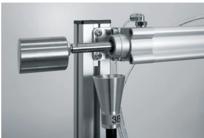
Abbildung 4: Partikelsonde am Messaufbau
