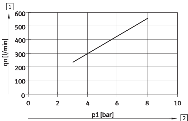
Fig. 7 Consumo de aire en función de la presión de funcionamiento del bloque de vacío
