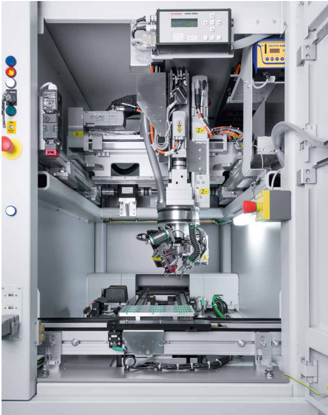
Adaptación eficiente: IPTe logra realizar todo el proceso de soldadura en un espacio mínimo.
