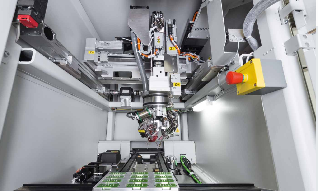
Zuverlässiges Handling, sicherer Betrieb: Spindelachse EGC, Zahnriemenachse EGC mit integriertem Messsystem, elektrischer Schlitten EGSL plus kundenspezifisches Modul auf ERMB Basis.
