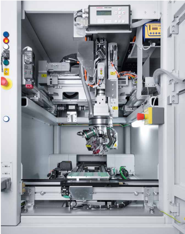
Effizient eingepasst: IPTE konzentriert den gesamten Lötprozess auf kleinsten Raum.
