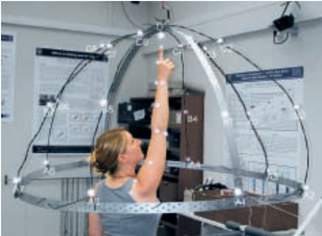
Versuchsaufbau: Arm und Ziele der Zeigebewegungen sind durch reflektierende Kugeln markiert.
