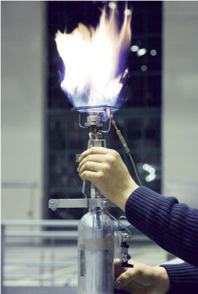
Überhitzerbrenner mit Dralldüse. Letzter Check vor dem Start.
