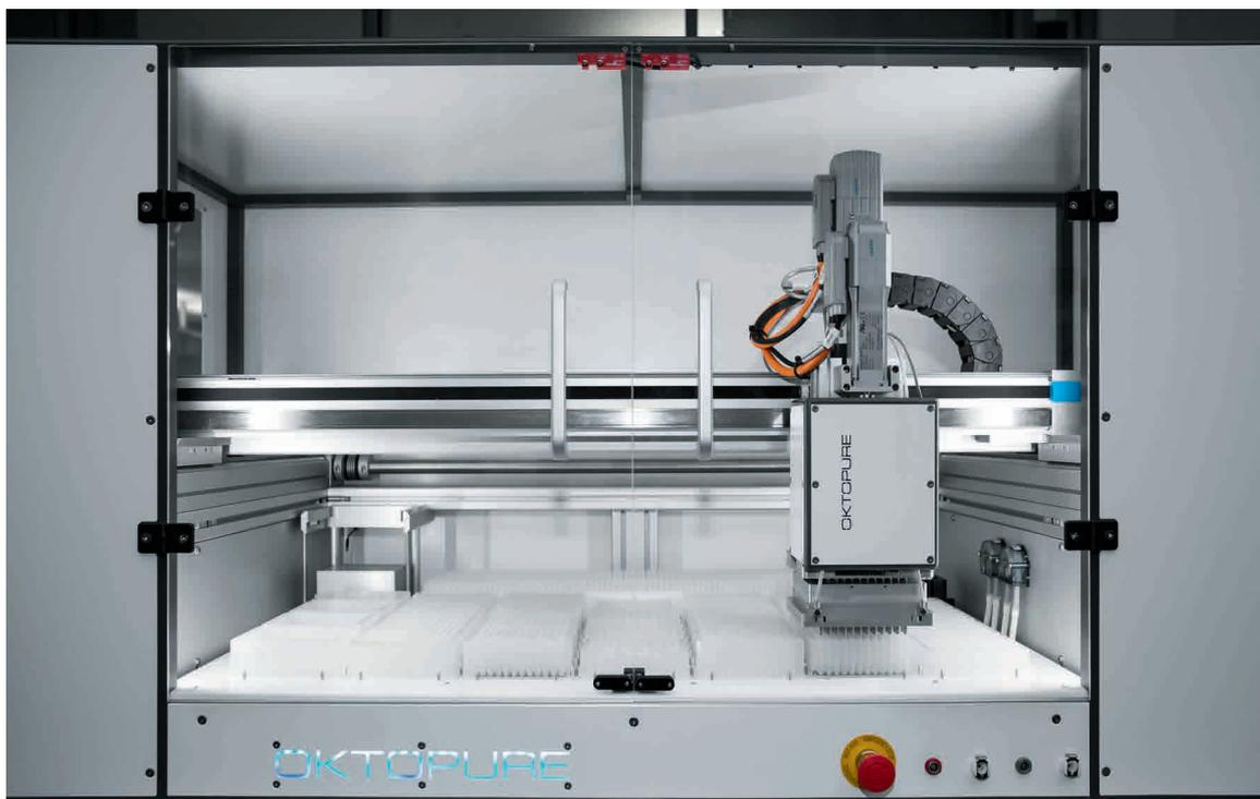
El elevado grado de automatización se explica gracias al sistema de manipulación de Festo. Los expertos de Festo, especializados en técnicas de automatización neumática y eléctrica adaptaron el sistema de manipulación específicamente a las exigencias que plantea su utilización en laboratorios.
