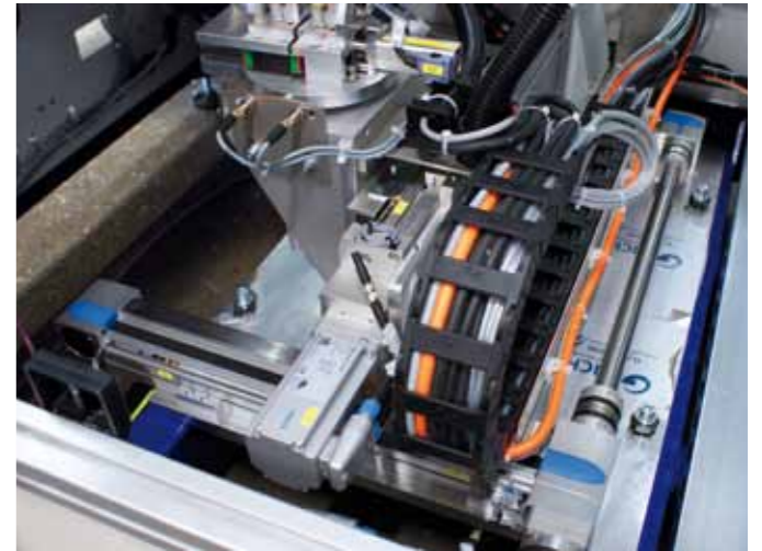
Ein weiteres Handling positioniert Warmnetzköpfe, um die Reflektoren am Kühlkörper zu befestigen.
