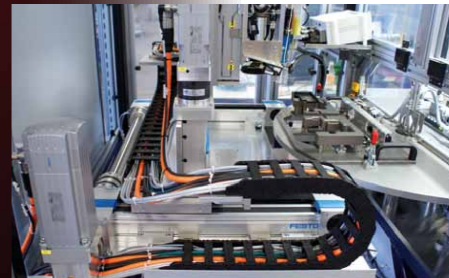
Ein einbaufertig geliefertes Handling sorgt für den gleichmäßigen Auftrag einer 2-Komponenten-Wärmeleitpaste.
